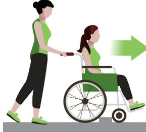
段差が5mm以下の場合には前輪も押し付けでOKです。
