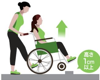
テッピングレバーを踏み込み、前輪を持ち上げて乗り越える。
