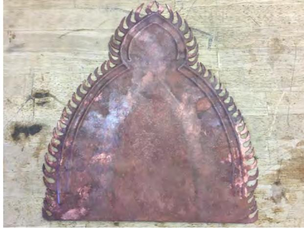
②焼鈍しを行い、金属線を背面に這わせ、プレス機で二重光背を成形する
