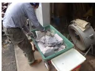
⑫ 十分除冷し、型を壊して铸物を取り出す
