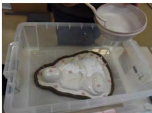
③ 石膏で铸型を補強する
