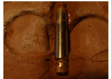
⑯鈕の穴の部分にステンレス棒を埋め込む
