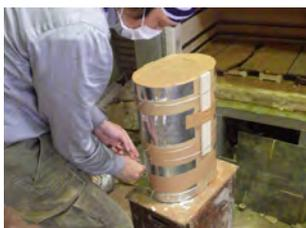
⑩ 石膏、砂、古材を混合した铸型剤を流し込む
