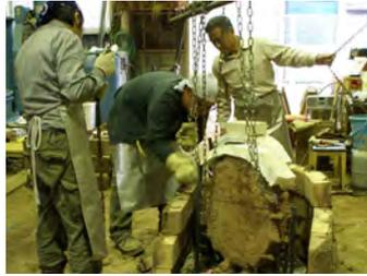
②窯を壊し、焼成した鑄型を移動する
