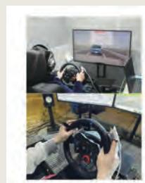
図 ドライビングシミュレータを用いた車内音実験の様子
