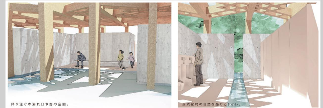
道の駅あわくらんどに建つCLTを用いた公衆トイレの提案です。厚みのあるCLTを、西粟倉村章を重ね合わせたパターンでくり抜き、自然換気が行えるよう壁と屋根を切り離しました。屋根から落ちる木漏れ日や影で村の時間の流れを表しています。
