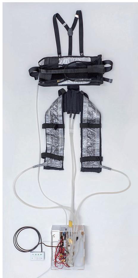
図7 失禁体験装置の全体図。腹部への空気圧迫機構と股間部への温水を用いた温感提示により尿失禁感覚を提示する。
